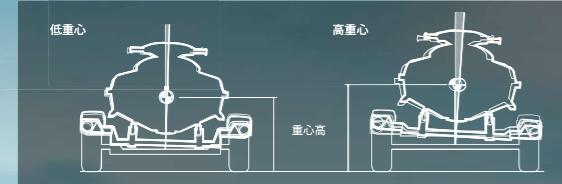
通常トレーラーは、本体より重い積載物を運ぶために重心位置が低いとコーナー時にロールが発生し、不安定になってしまいますが、当社のトレーラーは積載物を低く積載できるよう設計しています。
