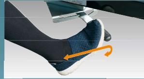
両手が塞がっている時でも片足でロック可能な駐車ブレーキレバーを採用したタイヤロック式駐車ブレーキシステムを採用しています。
