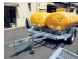
消防用水タンクトレーラー
