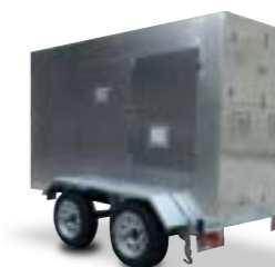
電源トレーラー
